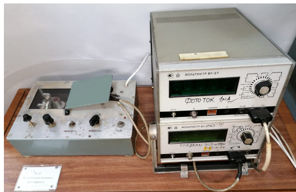
Рис. 6.2. Экспериментальная установка по исследованию внешнего фотоэффекта
